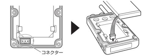
**4 バッテリーパックのケーブルを図のようにまとめ、バッテリーを押し込む**
