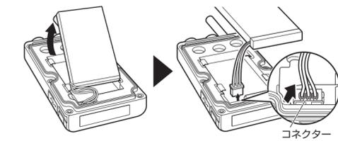
**3 バッテリーパックのコネクターを本体のバッテリー接続コネクターに接続する**
