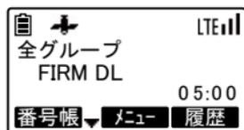
ファームエアダウンロードが完了すると、「FIRM OK」が表示されます。
