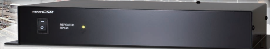
作業連絡用通信システム親機 RP848
